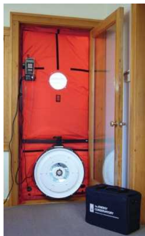
Uitvoeren van een blowerdoortest
