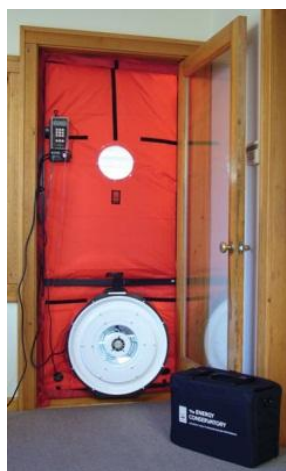
Foto : Uitvoeren van een blowerdoortest
