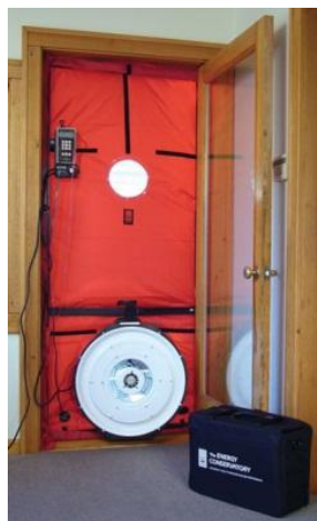
Foto : Uitvoeren van een blowerdoortest
