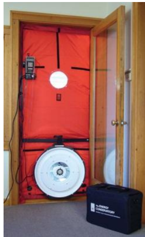
Foto : Uitvoeren van een blowerdoortest
