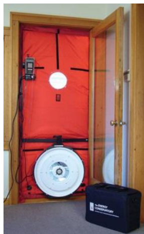
Foto : Uitvoeren van een blowerdoortest
